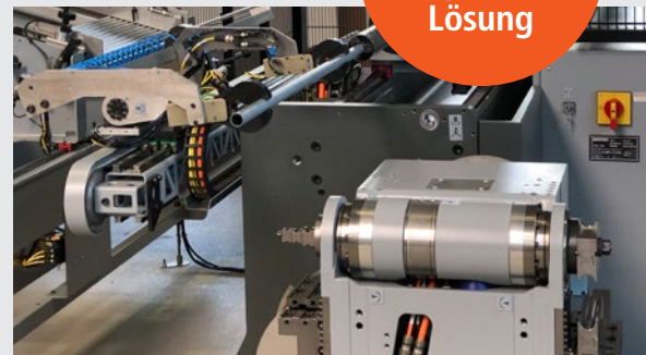
Wafios „RBV25 R“ – weltweit die einzige Maschinenvariante in der Ausführung mit 6 Meter Maschinenkörper.
